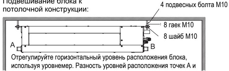
Отрегулируйте горизонтальный уровень расположения блока, используя уровень. Разность уровней расположения точек А и В блока должна составлять до 5 мм. Если отвод конденсата предполагается со стороны А, то точка А должна быть ниже точки В и наоборот.
